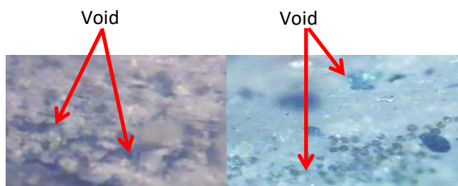
Gambar 4 Micrograph menggunakan Mikroskop Optik Perbesaran 10x
